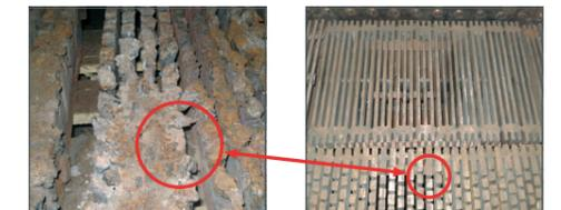
La très forte température et la mauvaise qualité du charbon ont provoqué l'usure des barreaux de la grille. Nouvelle grille.
